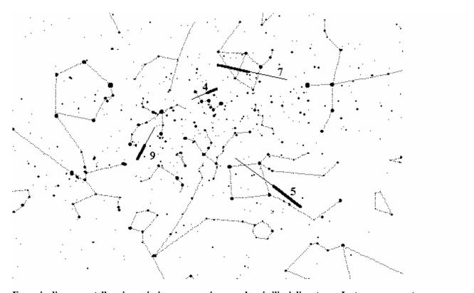
Esempio di mappa stellare in proiezione gnomonica con alcuni rilievi di meteore. Le tracce osservate vengono disegnate evidenziando il punto di inizio e di fine, e numerate cronologicamente.
